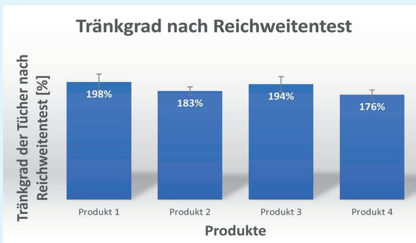
**Abb. 5:** Resttränkgrad der Tücher nach Reichweitentest. Arithmetische Mittel und Standardabweichung aus n=9.
