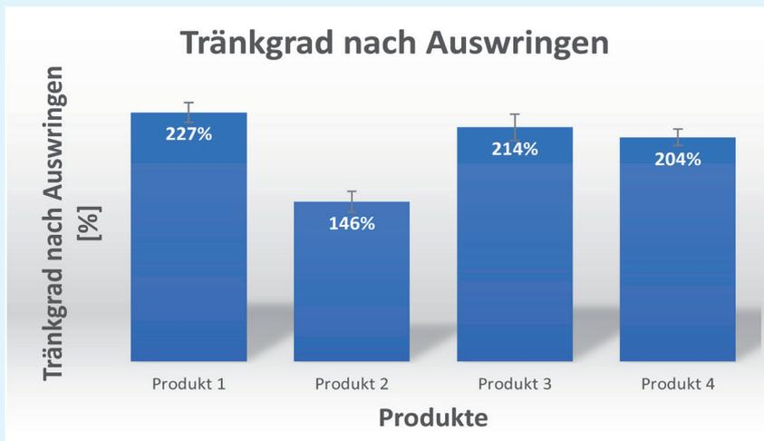
**Abb. 2:** Tränkgrad nach Auswringen der Tücher. Arithmetische Mittel und Standardabweichung aus n=3.
