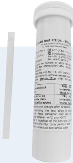
Bandelettes de test pour le contrôle de la concentration en acide peracétique (APA) (seuil de 900 ppm) dans les bains désinfectants à l'APA
